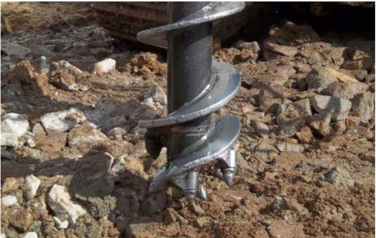
Trado de Hélice com Picos de Widea para Execução em Solos de Alta Resistência Widea Flight Auger for Highly Resistant Soil
